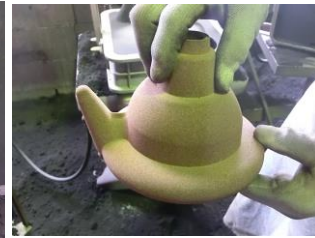
ザク鉄瓶の為に制作された 専用の中子(なかご)
