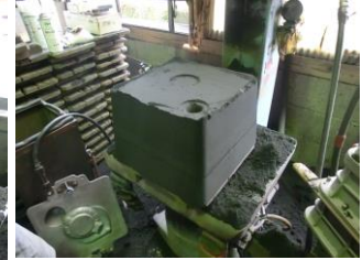
上型と下型を合わせ、砂枠を外して砂型が完了
