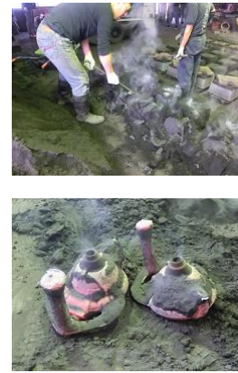
注湯(砂型に職人が一つ一つ溶解した鉄を流し込む) 鉄を途切れないよう温度が冷めないうちに注ぐ。
