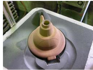
中子の設置が完了
