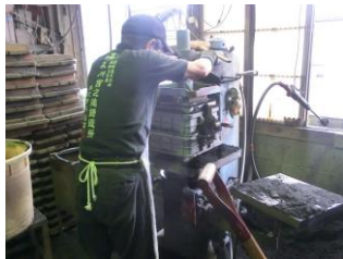
砂の中に隙間ができないように圧縮
