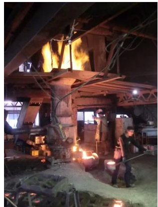
コシキと呼ばれる溶解炉で鉄を溶かす 鉄の溶解(1,400°C)
