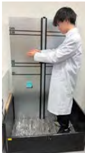
落下試験の様子 Drop testing a toy
