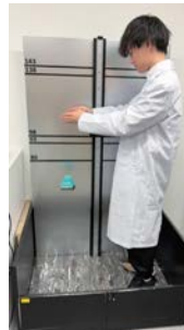
落下試験の様子 Drop testing a toy
