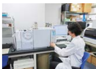
「ガスクロマトグラム質量分析装置」 身体に害を与える可能性のある規制化学物質の有無を検査
