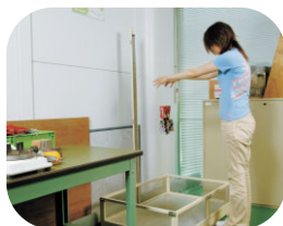
玩具を落下させる衝撃試験
