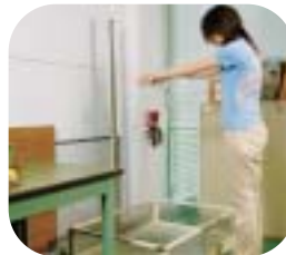
玩具を落下させる衝撃試験
