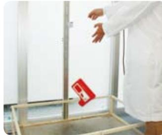
玩具を落下させる衝撃試験
