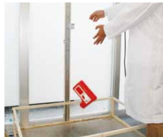
玩具を落下させる衝撃試験
