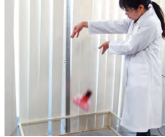
玩具を落下させる衝撃試験
