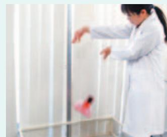
玩具を落下させる衝撃試験
