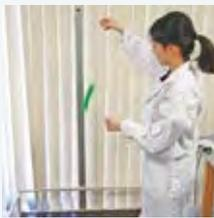
玩具を落下させる衝撃試験
