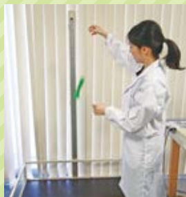
玩具を落下させる衝撃試験
