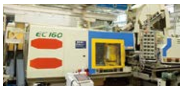
現在稼働中の4色射出成形機(多色成形機)
