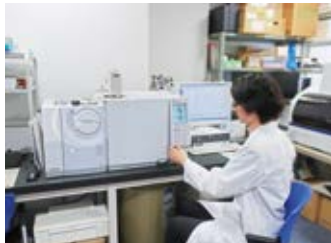
「ガスクロマトグラム質量分析装置」 身体に害を与える可能性のある規制化学物質の有無を検査
