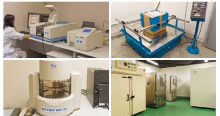
BANDAI (SHENZHEN) CO.,LTD.に導入されている検査機器の一部 左上：赤外線分析装置、右上：カートン振動試験機 左下：蛍光X線分析装置、右下：恒音槽（サイクル）試験機
