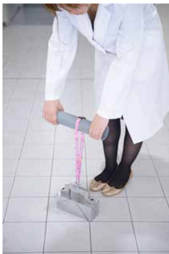
首にかけるストラップは、 引っ掛けても喉を圧迫しないよう、 ある一定の荷重を超えると 外れるか検査します。
