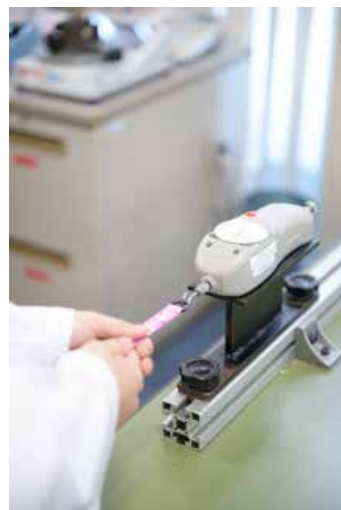
プッシュプルゲージ 子どもの力で引っ張っても 壊れないか、壊れる場合にも 安全かを検査します。
