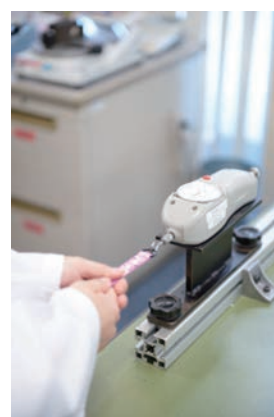
プッシュブルゲージ 子どもの力で引っ張っても 壊れないか、壊れる場合にも 安全かを検査します。
