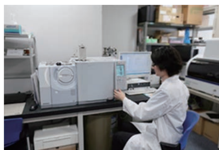
ガスクロマトグラム質量分析装置 身体に害を与える可能性のある 規制化学物質の有無を検査します。
