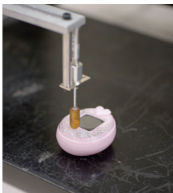
ボタン耐久試験機 想定された使用回数に応じて、ボタンの耐久性を確認します。
