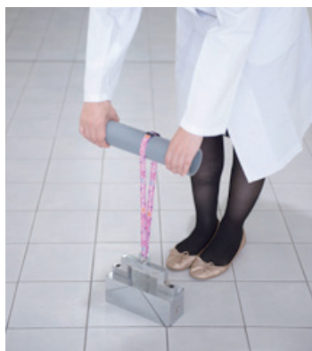
首にかけるストラップは、引っ掛けても喉を圧迫しないよう、ある一定の荷重を超えると外れるか検査します。
