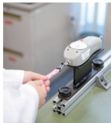
プッシュブルゲージ 子どもの力で引っ張っても壊れないか、壊れる場合にも安全かを検査します。
