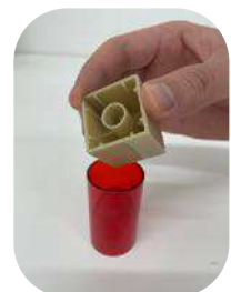
誤飲防止目的のスモール パーツシリンダーを 使った試験
