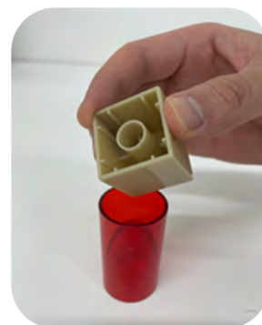
誤飲防止目的のスマールパーツシリンダーを使った試験
